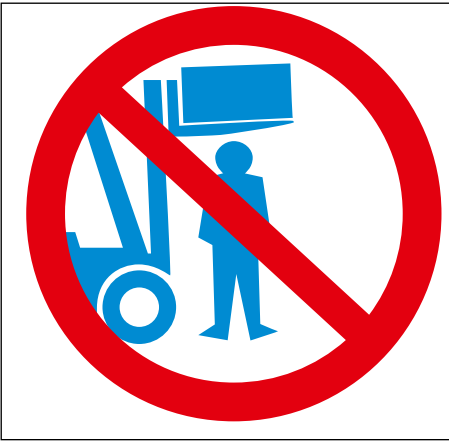
Bild 2-3: Anschlag „Aufenthalt unter der Last verboten“
