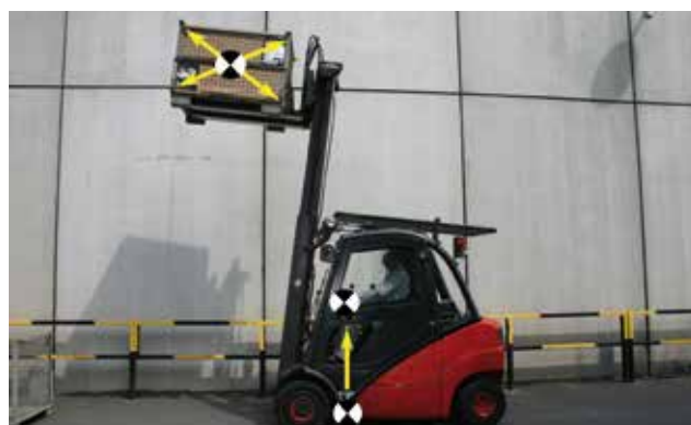
Bild 6-22: Verlagerung des Gesamtschwerpunktes bei angehobener Last
