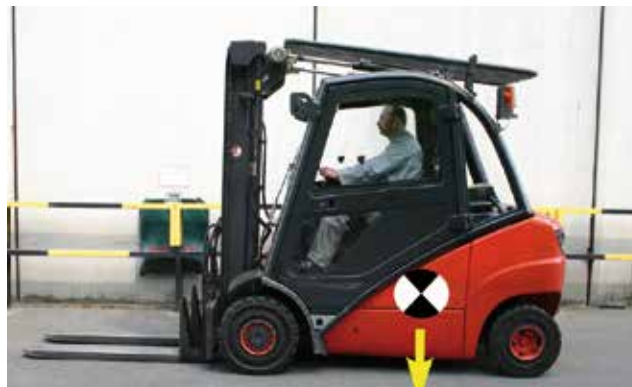
Bild 6-19: Der Schwerpunkt des Gabelstaplers und ...
