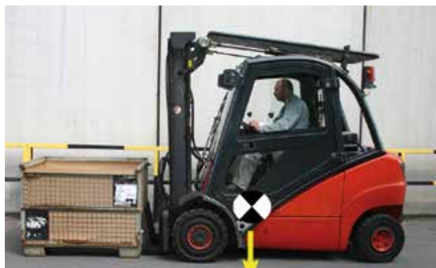
Bild 6-21: ... ergeben den Gesamtschwerpunkt bei abgesenkter Last
