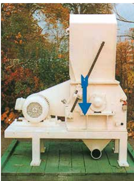
Bild 6-12: Bei dieser Zerkleinerungsmaschine liegt der Schwerpunkt außermittig. Eine einfache, aber eindeutige Kennzeichnung gibt dem Gabelstaplerfahrer einen Hinweis, ...
