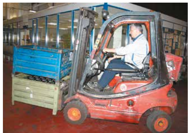
Bild 6-14: Nach hinten geneigter Hubmast
